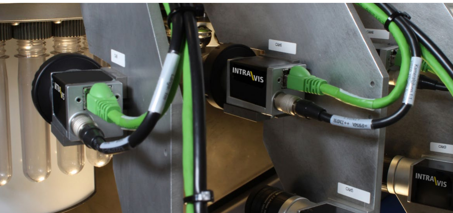
PreWatcher III 系统里有六个相机检测物件的侧面
