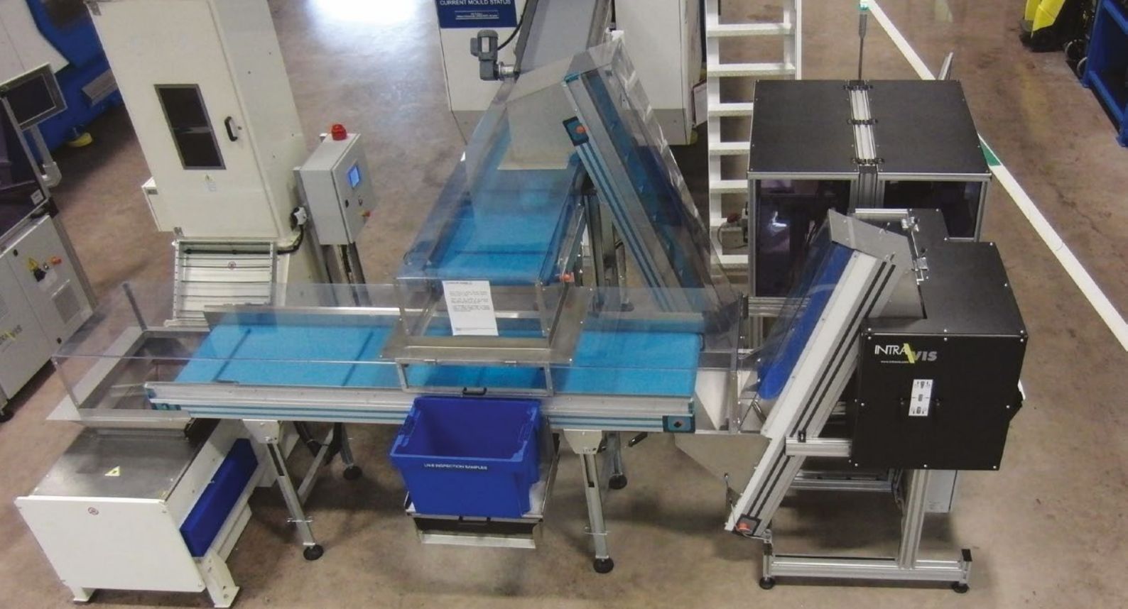
在注塑机后面的 Sample-PreWatcher 在线检测系统
