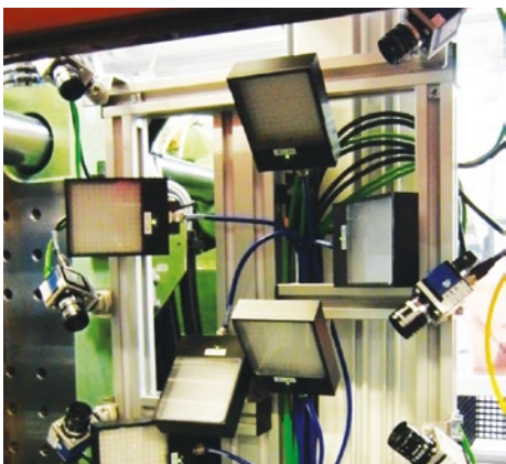
特殊的照明设备和相机检测模内贴标标签
