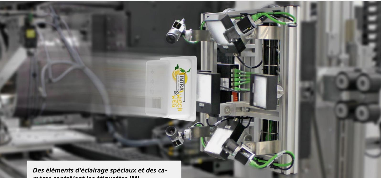
*Des éléments d'éclairage spéciaux et des caméras contrôlent les étiquettes IML*
