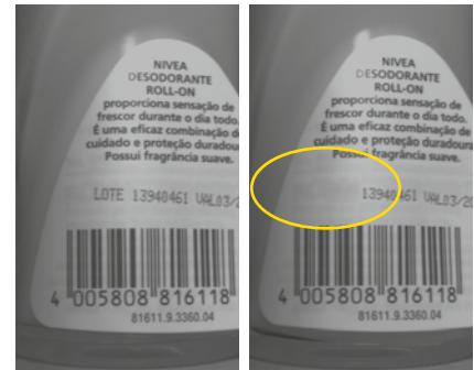
装备有额外的 LCP 检查模块，LabelWatcher 系统识别图样缺陷
