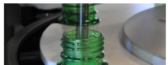
谱仪检测瓶胚的颜色
