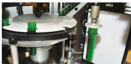
系统使用吸盘旋转和检测每个瓶胚
